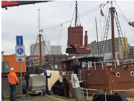
Nieuwe pijp wordt aan boord gezet
