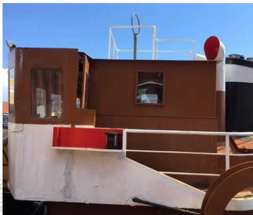
Richtingzoeker met hekwerk op de brug
